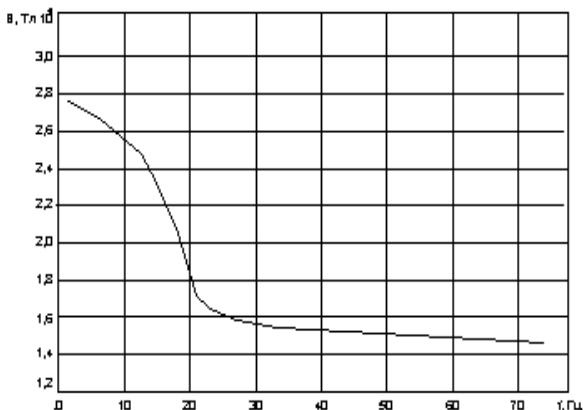
Рис. 3. Зависимость индукции магнитного поля в центре гелиевого сосуда от частоты тока 0,2 А в катушках Гемгольца
